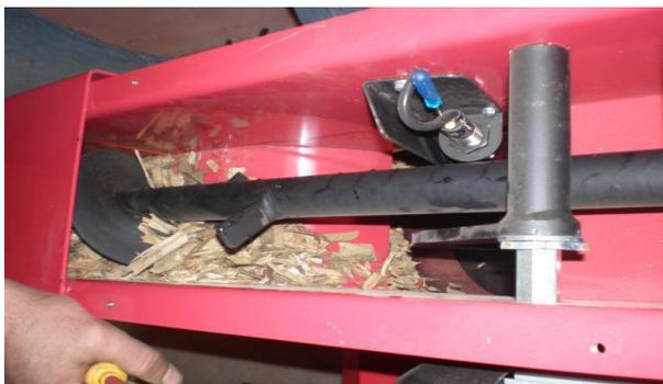
Förderschnecke und Fallschacht ( Sensorjustierung mit blauem Schraubendreher)
